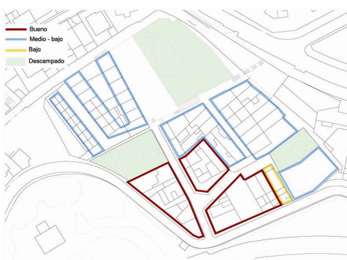
Estado de conservación de las viviendas dividido en tres grupos: bueno, medio, bajo.
